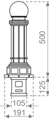
Dissuasore stradale in ghisa, stile OSLO, di altezza 500 mm dal piano di calpestio e base 191 mm, costituito da un colonnino prismatico cavo di sezione e base ottagonale ornato alla sommità da un pomello sferico. Base ottagonale con apposita zoccolatura per l'ancoraggio fisso in fondazione.
