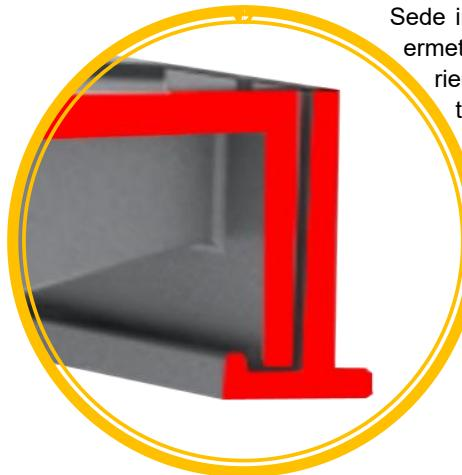
Sede interna a "U" per ottenere la ermeticità agli odori mediante riempimento di sabbia e/o materiali equivalenti in accoppiamento col coperchio. Telaio con canaletta interna di appoggio del coperchio continua, senza interruzioni per tenuta idraulica.
