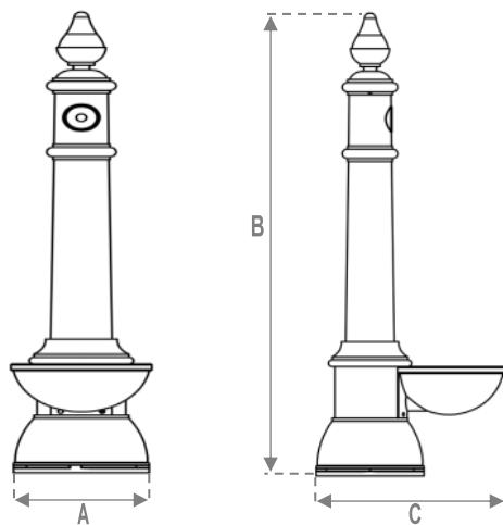
Fontana in ghisa stile NAPOLI completa di rubinetto in ottone del tipo a leva oppure a pulsante, costituita da un corpo tronco conico cavo delimitato, nella parte inferiore, da vasca di forma circolare munita di griglia superiore per l'appoggio, e nella parte superiore da un pomo a forma conica.
