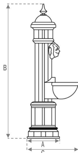
Fontana in ghisa stile ROMA completa di rubinetto in ottone del tipo a leva oppure a pulsante, costituita da un corpo prismatico cavo delimitato, nella parte inferiore, da vasca di forma circolare munita di griglia superiore per l'appoggio, e nella parte superiore da un decoro raffigurante una testa leonina, chiusa alla sommità da un coperchio con puntale.
