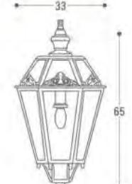
Lanterna esagonale per montaggio portato e sospeso, realizzata in FE zincato UNI EN 1461 con decori ornamentali in fusione di alluminio.
