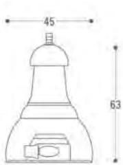
Lanterna per il montaggio sospeso e dotata di tronchetto filettato  $\frac{3}{4}$  Gas.
