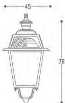
Lanterna quadrata per il montaggio portata e sospesa, realizzata in alluminio presso fuso UNI EN 1706.
